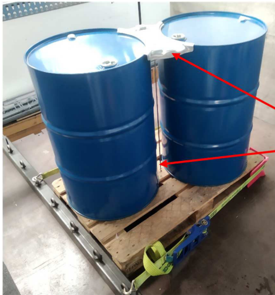
Abbildung 4-28 Versuchsaufbau Stahlspundfässer(links) und gemessene Verschiebungen (rechts)
