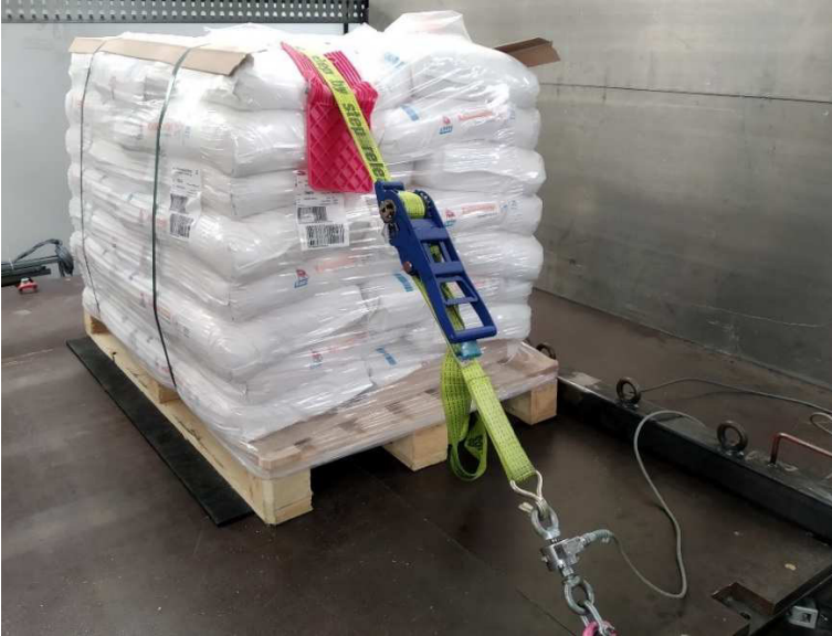
Abbildung 4-26 Versuchsaufbau Sackware Kaliumsulfat
