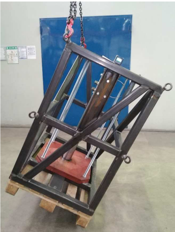
Abbildung A-4 Versuchsaufbau zur Schwerpunktbestimmung der RCU, kurze Seite der RCU
