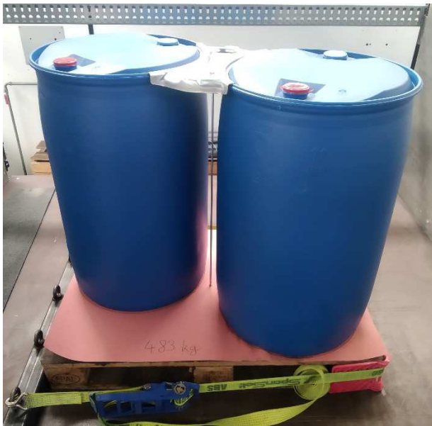
Abbildung 4-29 Versuchsaufbau Kunststofffässer mit Antirutschmatte (links) und gemessene Verschiebungen (rechts)
