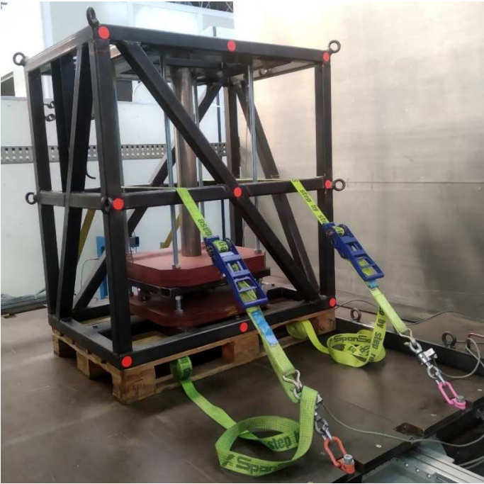
Abbildung A-12 Versuchsaufbau Niederzurren, untere Zurrhöhe l_v = 772 mm
