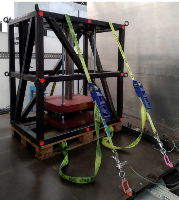
Abbildung A-12 Versuchsaufbau Niederzurren, untere Zurrhöhe l_v = 772 mm
