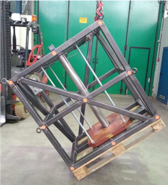
Abbildung A-3 Versuchsaufbau zur Schwerpunktbestimmung der RCU, lange Seite der RCU
