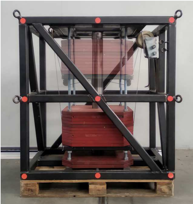
Abbildung 3-13 Umsetzung Schwerpunktverstellung der RCU
